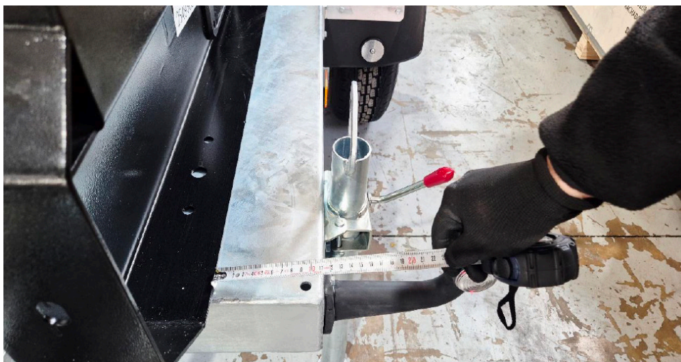
Vérification des dimensions de la partie avant (côté gauche).
